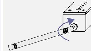
Halten Sie den Adapter fest. Lösen Sie anschließend das Röhrchen durch eine Drehbewegung vorsichtig von der Pumpe.
