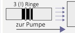
Entnehmen Sie das Probenröhrchen und ziehen Sie die Kappe auf der Seite mit den **drei** schwarzen Ringen ab. Stecken Sie diese Seite dann auf den Gummiadapter an der Pumpe.
