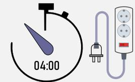
Stecken Sie das Netzteil der Pumpe in die Steckdose und starten zeitgleich ihre Stoppuhr/ihren Timer. Die Raumluftpumpe darf nur die auf der Pumpe angegebene Zeit in Betrieb sein.
