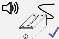
Testen Sie die Funktion der Pumpe. Sie erzeugt einen leisen Brummtön. Der Luftstrom ist nur minimal zu spüren. Trennen Sie die Pumpe danach wieder vom Strom.
